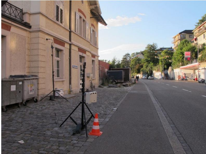
Abbildung 13. Mikrofonsystem und Seitenradargerät, welches Fahrtrichtung Zürich Zentrum erfasst.
