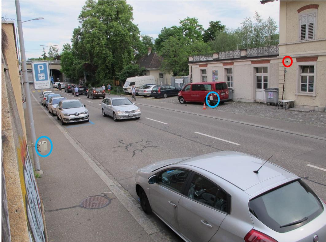
Abbildung 11. Foto von Messquerschnitt an der Wasserwerkstrasse 93. Rot eingekreist ist das Mikrophon und blau eingekreist die zwei Seitenradargeräte.
