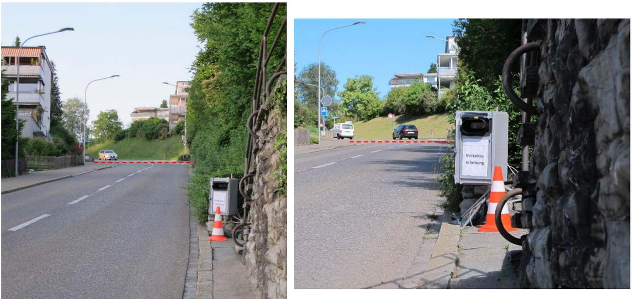
Abbildung 10. Kennzeichenerfassungskamera. Blick in Richtung Messquerschnitt (rot gestrichelt).
